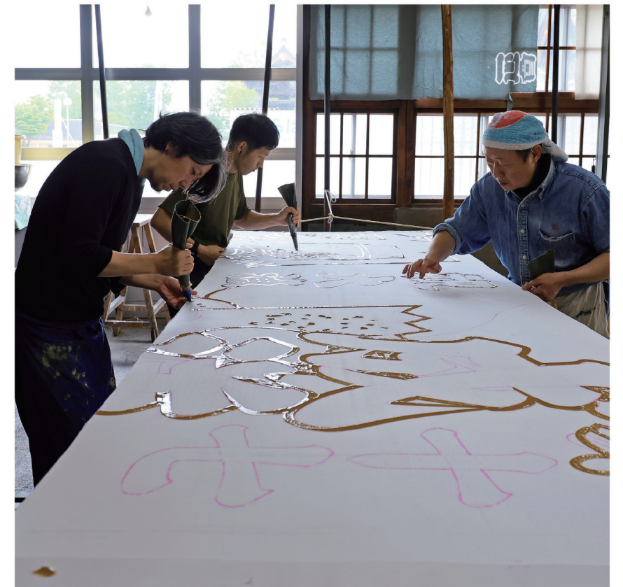
下絵に沿って防染のりを置いていく「のり置き」。繊細な技が求められる工程です
